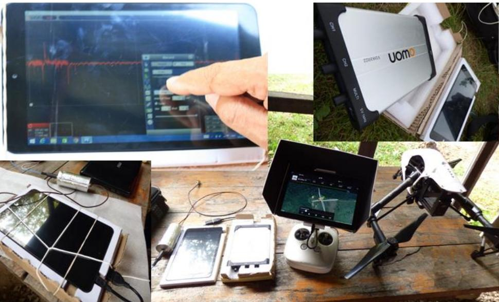
MT metodama snimaju se električna i magnetna polja u opsegu niskih i veoma niskih frekvencija (Infra zvuk-Audio-Ultra zvuk). Izvori MT i AMT signala mogu biti umjetni ili prirodni.
